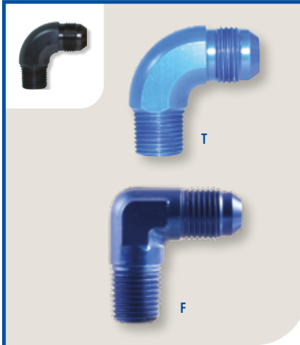
X141 - Adaptateur JIC mâle 90° NPTF mâle - AN822
